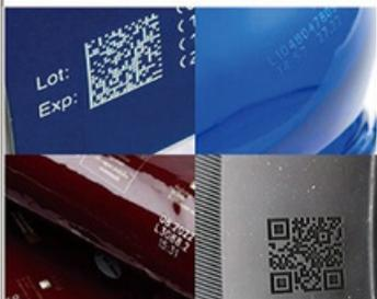
採用1064nm波長雷射管，可對各種材料的零件加工，包含金屬合金、非金屬、塑料等材料
